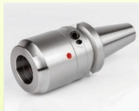
ミーリング加工対応のハイドロチャックです。デメリットが少なく、幅広い用途に対応します。スリムタイプにつき微細な形状加工に適しています。焼ばめ同様の使用用途が可能であり、工具交換時に高価な焼ばめ装置は不要です。油圧クランプ技術による優れた振れ精度と制振機能が工具寿命の延長を実現しました。様々な工具シャンクに対応しており、最少クランプ径3mmから20mmまで対応しています。3Dプリンターで製作されており、従来は加工ができなかった、細くて、長い形状が実現されました。油圧スリーブと本体のろう付整合をなくし170℃までの温度条件下で安定的なクランプを実現するなど、積層造形法(3Dプリンター)によるツールの先駆けとなる商品です！
